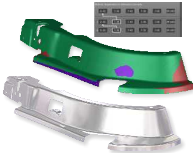
Compensación de la operación D20 basada en el springback medido después de la operación de corte - los resultados están en un 90% dentro del nivel de tolerancia.
