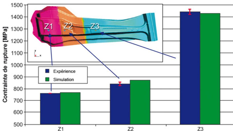
Une comparaison de mesures des résultats de simulation démontre qu'AutoForm-ThermoSolver calcule avec précision la contrainte de rupture.
