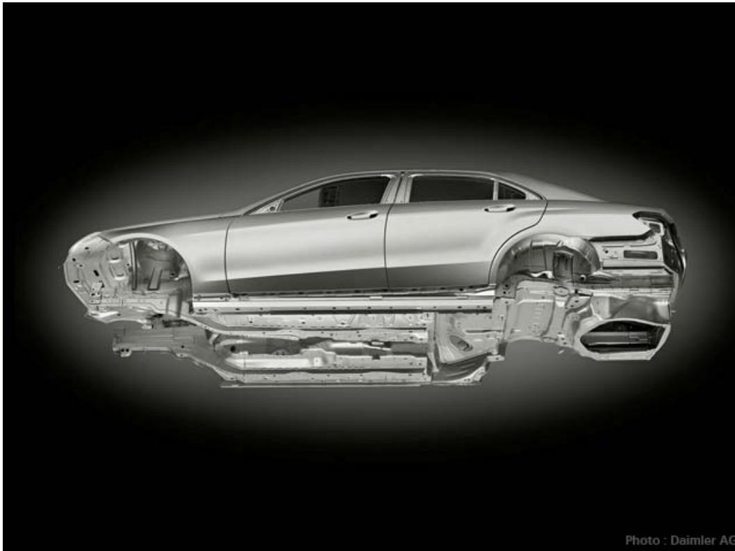
La quantité d'acier à haute limite élastique et très haute limite élastique dans la fabrication de la nouvelle Mercedes-Benz classe E la propulse au premier plan.
