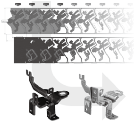
図8 3D デザインインターフェイスによる 順送シミュレーション設定
