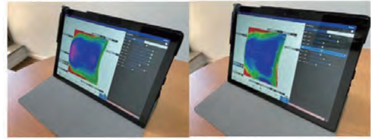
그림 5. 드로우비드 형상 변화에 따른 스프링백의 변화
