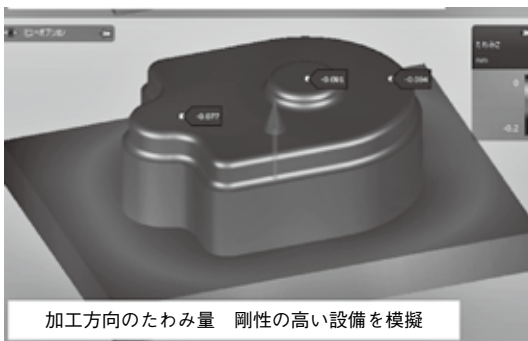
図6 剛性の高い設備を模擬したたわみ量
