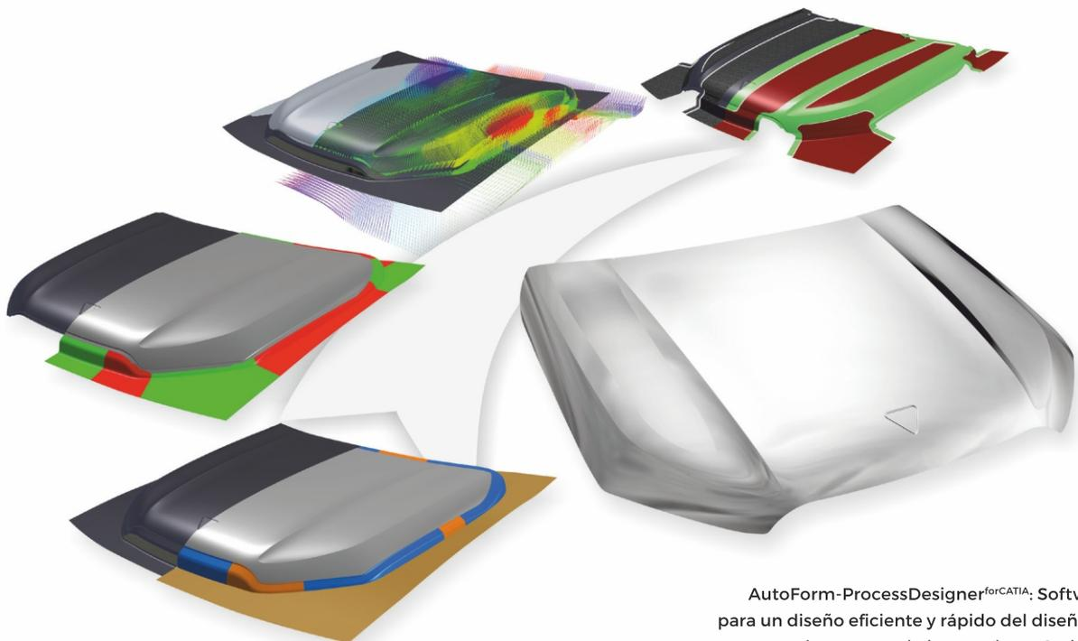
AutoForm-ProcessDesigner<sup>forCATIA</sup>: Software para un diseño eficiente y rápido del diseño de procesos de estampado integrado en Catia V5.
